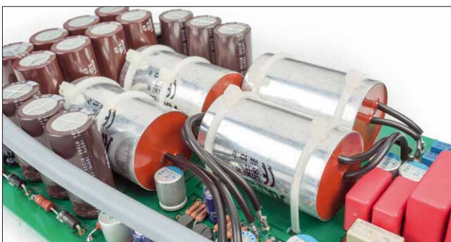
Auch bei der Spannungsaufbereitung hat man nicht gespart: Die Siebkondensatoren sind mit Folienkondensatoren gebrückt
