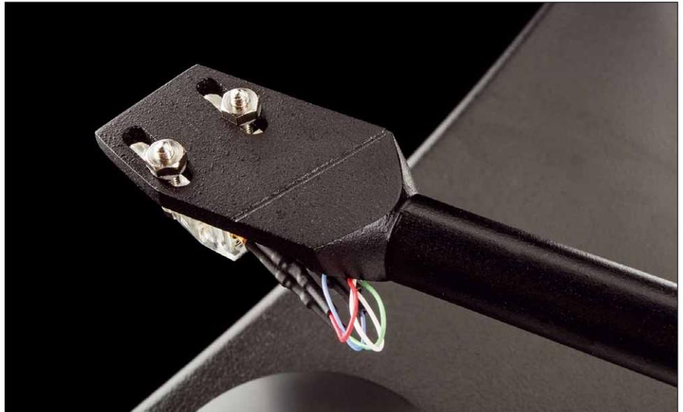
Am Übergang zwischen Armrohr und Headshell kann man die Herkunft aus dem 3D-Drucker gut erkennen – alles ist aus einem Stück
